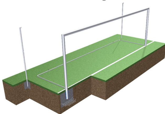
El marco de la portería, los dos postes verticales y el larguero se fabrican de perfil de aluminio extrusionado de sección nervada circular u ovalada.
